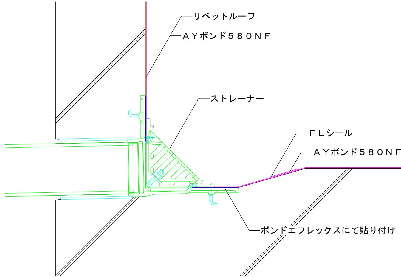
●防水性能の向上のため、額の広いドレンの採用を推奨します。(防水層張り掛け幅100mmタイプのドレンを推奨します。)
